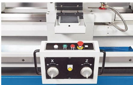
Kompakte Bedieneinheit mit elektronischen Handrädern
