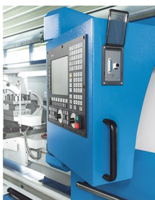
Schnittstelle zur Datenübertragung, schwenkbare Steuerungsbedieneinheit
